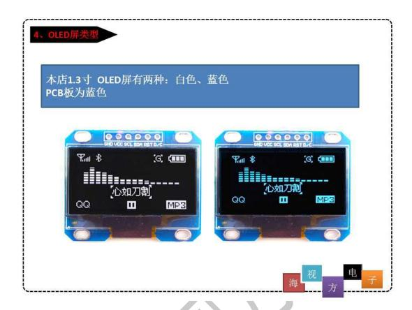
五、通讯模式: 4线 SPI、IIC 接口
